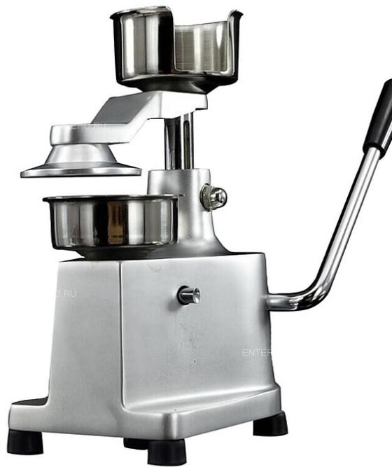
Пресс для гамбургеров \*\*Foodatlas HM-130\*\* используется на предприятиях общественного питания и торговли для формирования мясных заготовок круглой формы разной толщины из мясного или рыбного фарша. Модель оснащена рычагом для формирования котлет. Корпус выполнен из алюминия, чаша для бумаги и пресс-чаша - из нержавеющей стали 304, ножки - из резины.
